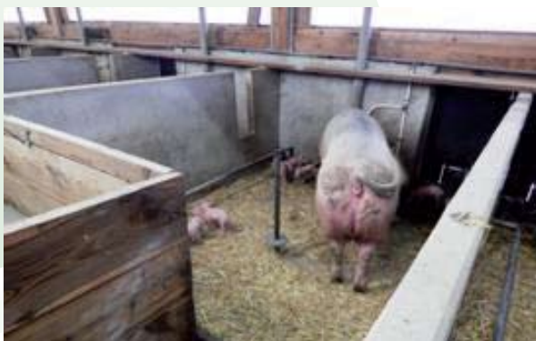
Slika 19: Postavitev boksov za prasitve brez vkleščanja svinj z izpusti
