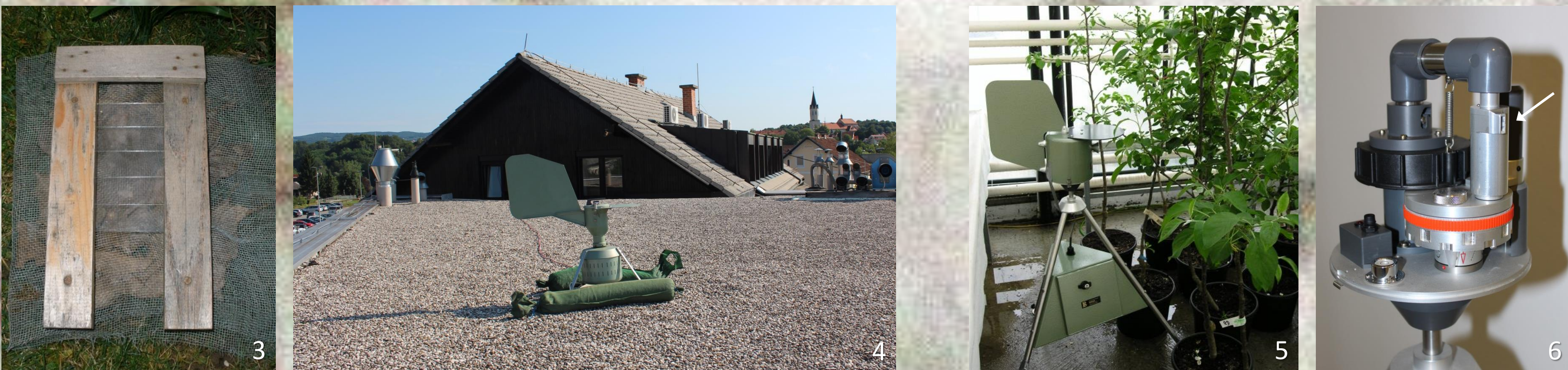
Slike 3 do 6: Meritve po kvalitativnih metodah z vazelinskimi objektimi stekelci (3) in Hirst-ovim modelom 7- dnevnega lovilca spor Burkard (4) med spremljanjem koncentracije peloda na strehi KGZS – Zavoda Novo mesto ter ciklonski model lovilca spor Burkard (5), ki omogoča meritve po kvantitativni metodi. Aluminijast cilindar (6) v katerem po vsesanju med vrtnčenjem zraka zastane večina vzorčenih delcev je označen s puščico. Foto: D. Bajec Figures 3 to 6: Qualitative method measurements with Vaseline slides (3), Hirst model of 7- day Burkard spore sampler (4) monitoring pollen concentration on KGZS – Zavod Novo mesto rooftop and cyclone model of Burkard spore sampler (5) which enables quantitative measurements. Aluminium cylinder (6) where deposits most of the sampled particles is marked with arrow. Photo: D. Bajec
