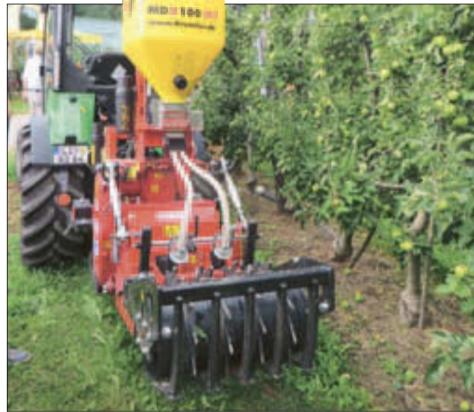
Sejalnica za pasovno dosejavanje nekonkurenčnih zeli in trav v vrstnem prostoru nasada (Fotografija: M. Mavsar – KGZ Novo mesto)
