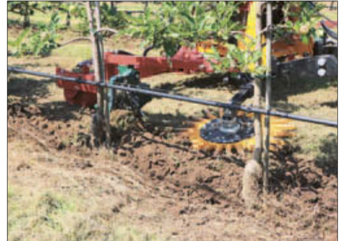
Plitva površinska obdelava tal v vrstnem prostoru nasada s pomočjo mehanske gnanega okopalnika, na katerem sta nameščena prstni valjar, ki zareže v tla, in prstni krožnik, ki s pomočjo nožev zmrvi vrhno plast tal. (Fotografija: M. Dolenshek – KGZ Ljubljana)
