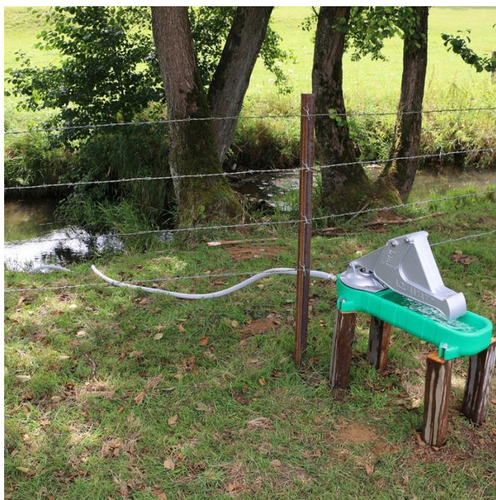
Slika 2: Membranska pašna črpalka z enim napajalnim mestom.
