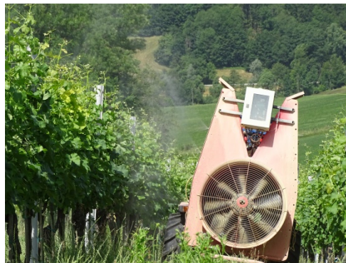
Slika 8: Pršilnik z LIDAR senzorji
